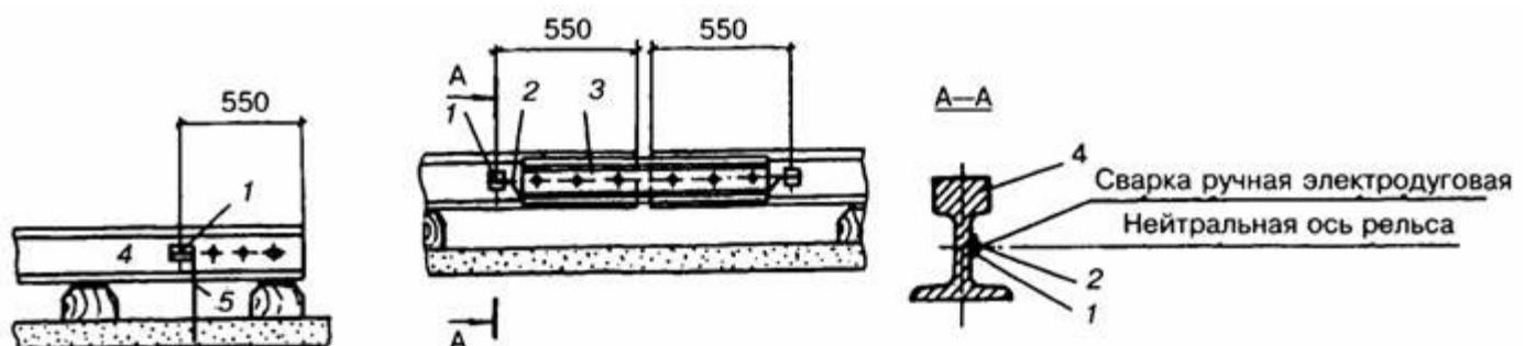
1 — промежуточная пластина; 2 — перемычка; 3 — накладка; 4 — рельс;
