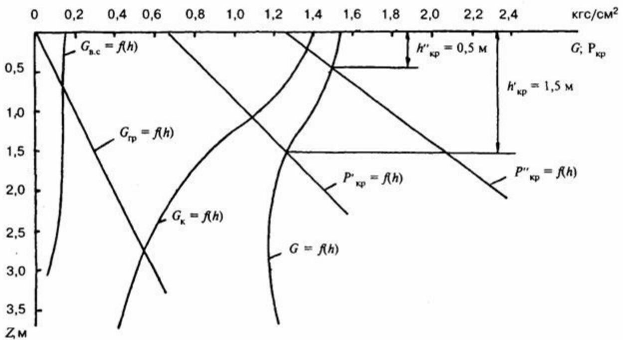
Рисунок И.3 — Распределение по глубине эпюор напряжений и критических нагрузок
