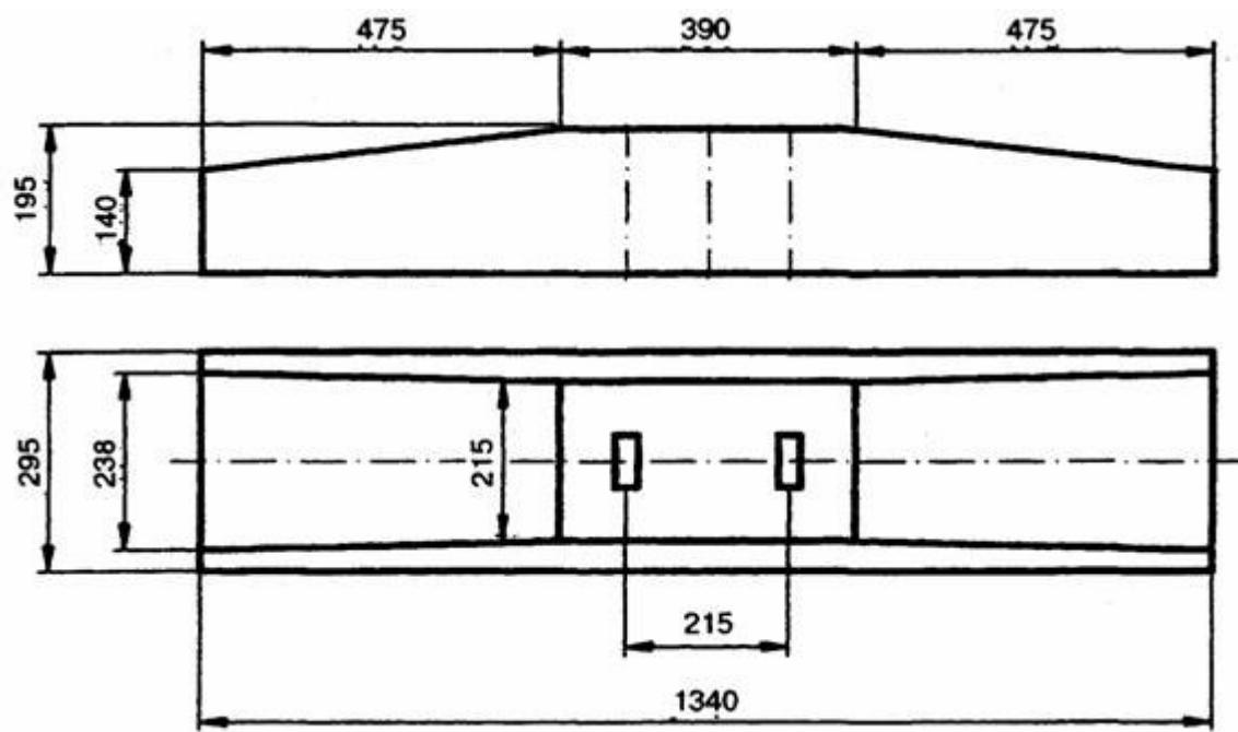
Б3. Железобетонная балка типа БРП-62.8.3
