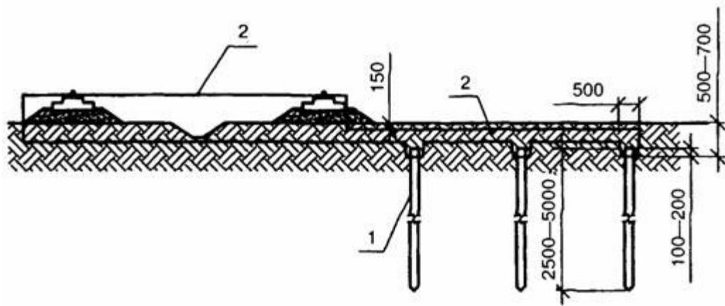
1 — заземлитель; 2 — заземляющий проводник
