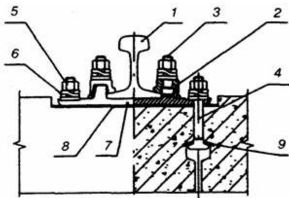
1 — рельс; 2 — жесткая клемма; 3 — клеммный болт; 4 — закладной болт;
