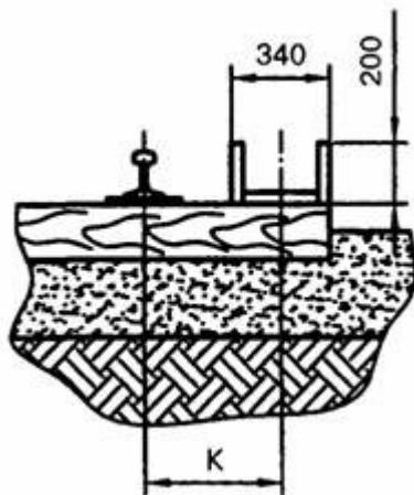
Лоток для укладки кабеля для крана, оборудованного кабельным барабаном
