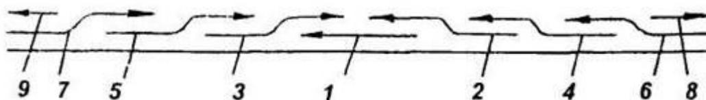
9.2.5.3. Наложение многослойных швов следует выполнять обратно-ступенчатым способом согласно рисунку. Каждый последующий слой выполнять после остывания предыдущего и очистки от шлака. При этом длина каждого шва не должна превышать 200 мм.
