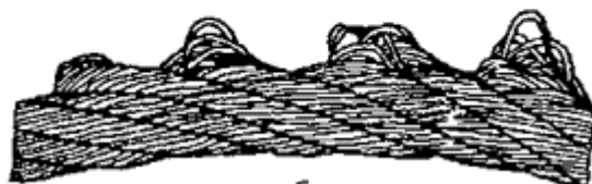
Рис. 12. Выдавливание проволок прядей: a - в одной пряди; б - в нескольких прядях
