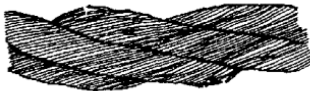
Рис. 1. Обрывы и смещения проволок каната крестовой свивки
