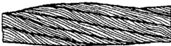
Рис. 13. Местное увеличение диаметра каната
